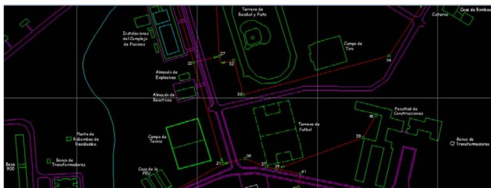
Figura 3. Vista en AutoCAD de la zona del SEDER – Facultad de Construcciones. (Rojo: Red Principal, Azul: red Secundaria, Verde: Edificaciones)
